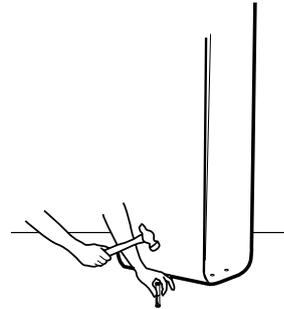
Taper avec un marteau sur les pointes des boulons d'ancrage (pièce 4) jusqu'à ce que le dessus de celles-ci soit au niveau du sol.
