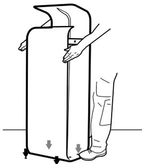
Placer la poubelle au-dessus des trous. Mettre les rondelles (pièce 3) sur les boulons (pièce 2).
