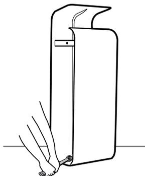
Serrer les boulons dans le sol avec une clé plate de 17 mm
