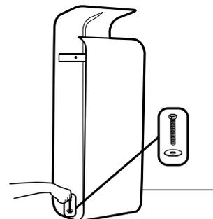
Insérer les pointes des boulons d'ancrage dans les trous de la poubelle puis dans le sol. Serrer à la main pour commencer.
