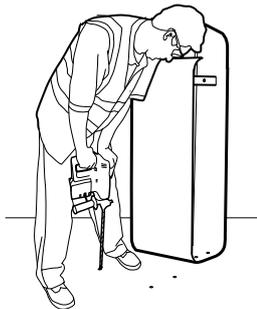
Percer les trous à une profondeur de 80 mm au moyen de la mèche de 16 mm. Évacuez la poussière des trous en brossant ou soufflant dessus.
